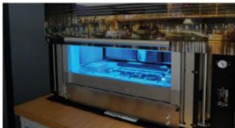
Die digitale Fertigung von Dentalprodukten erfolgt mittels CAD/CAM-Anlage.
